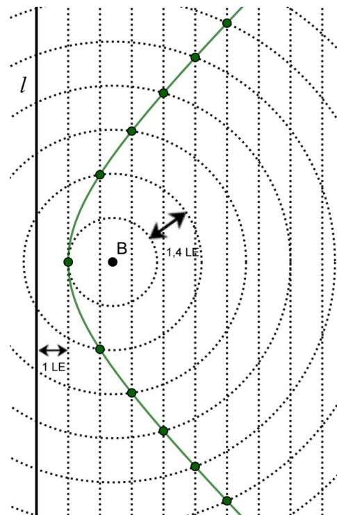
Für jeden Punkt  $P$  eines Kegelschnitts ist sein Abstand vom Brennpunkt  $B$  das  $\epsilon$ -fache ( $\epsilon > 0$ ) seines Abstandes zur Leitgerade  $l$ . Den Proportionalitätsfaktor  $\epsilon$  nennt man *numerische Exzentrizität* und teilt die Kegelschnitte nach seinem Wert in drei Typen ein:
