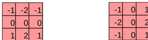
Abb. 19: Sobel-Filter für waagerechte und senkrechte Kanten
